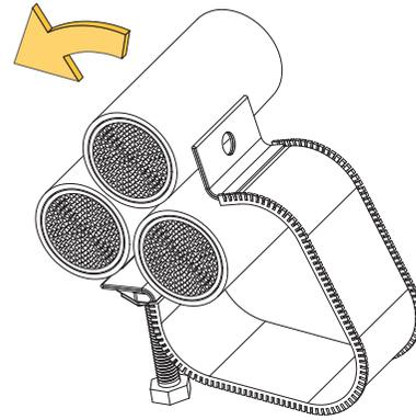
3. POSITION RESTRAINT AROUND CABLES
